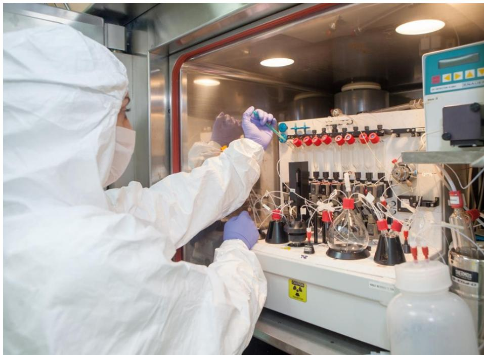
Figura 2.11: Módulo de síntesis Tracerlab FX-FN
