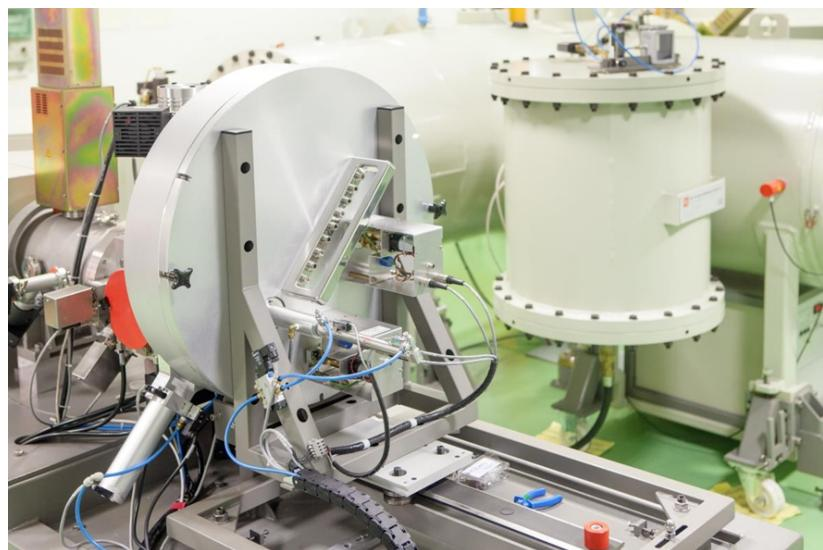
Figura 2.14: Carrusel de almacenamiento de muestras/ Sample carousel
