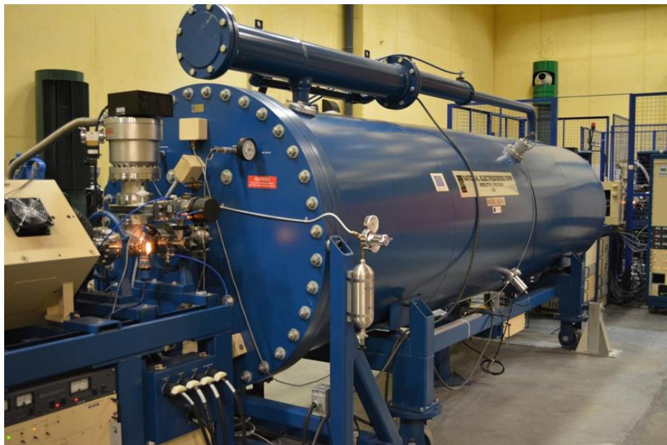
Figura 2.1: Acelerador Tándem de 3 MV / 3 MV Tandem Accelerator
