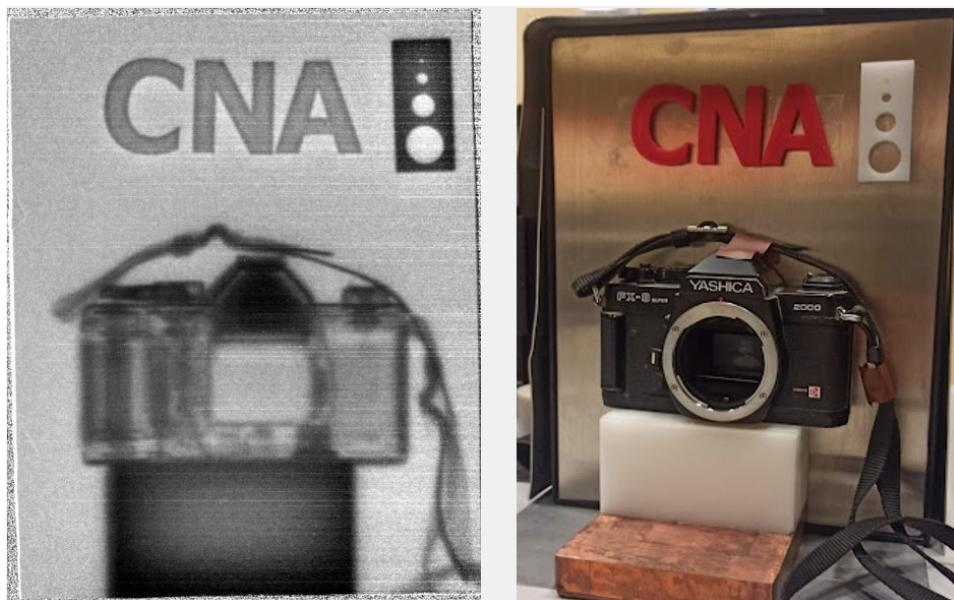
Figura 3.11: Radiografía mediante neutrónicos térmicos en HiSPANoS. Thermal neutron radiography at HiSPANoS
