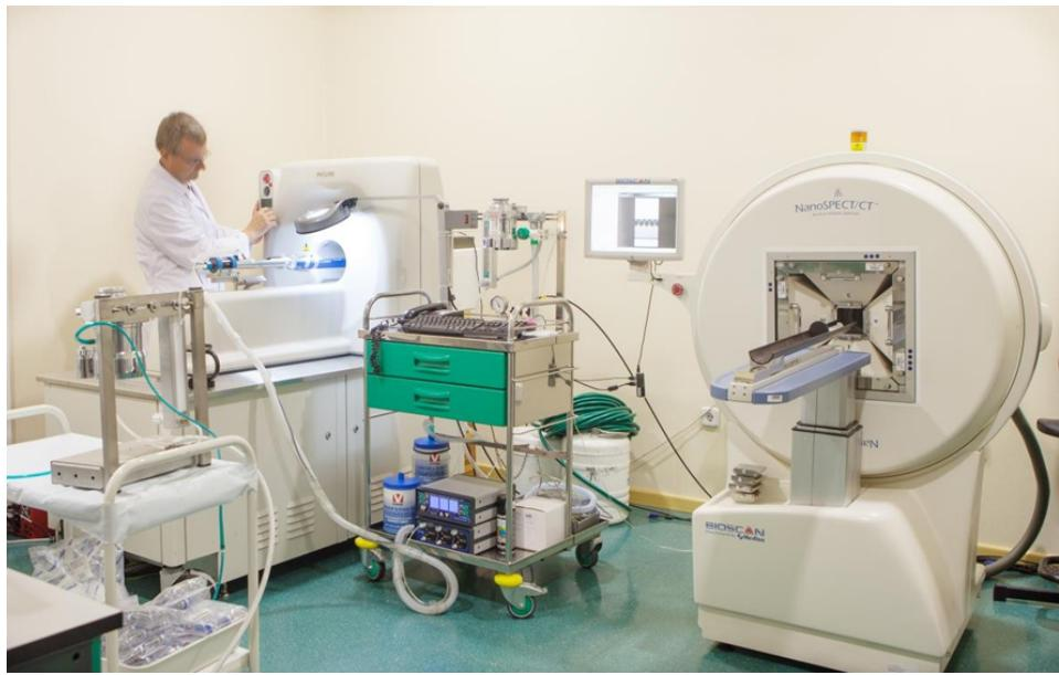
Figura 2.12: Sala del tomógrafo microPet y microTAC para pequeños animales/ Small animal microPET and microCT
