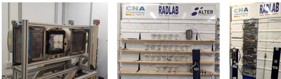
Figura 3.9: Ensayos de irradiación de muestras orgánicas en RadLab / Irradiation testing of organic samples in RadLab
